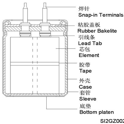
7-2 工艺芯包分解图 (Element drawing)
